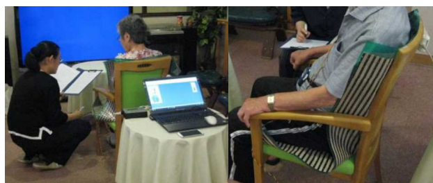
Fig. 4 体圧分布測定と骨盤傾斜角度の測定
