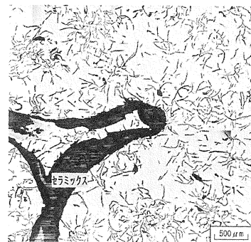
Fig.3 高りん鑄鉄/セラミックス複合材のSEM像
