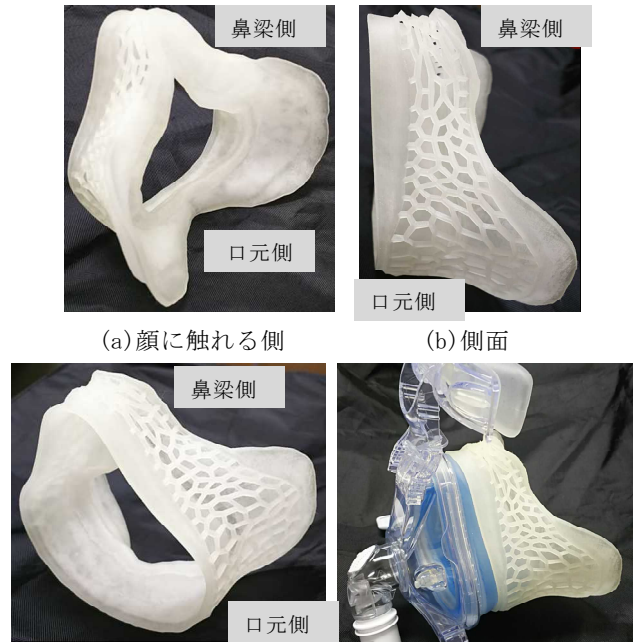
(c)マスクと組合せる側 (d)マスクとの組合せ Fig. 12 3Dプリンタによる試作(シリコンゴム)
