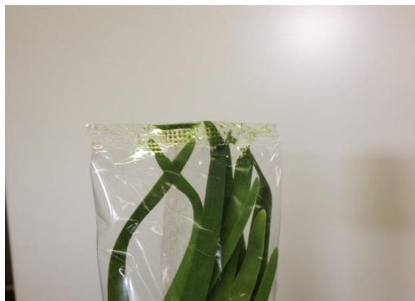
Fig. 4 トップシールのニラの噛み込み
