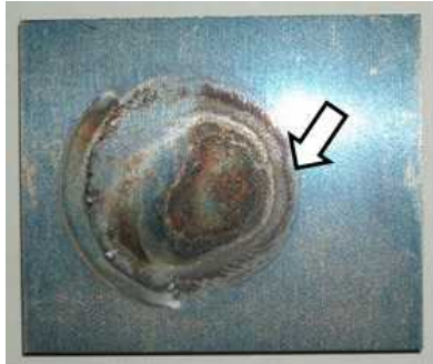
Fig.2 実験後のステンレス鋼板表面
