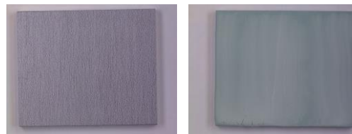
Fig.2 耐熱皮膜の塗布(左:塗布前, 右:塗布後)
