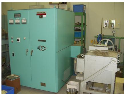
Fig.2 高周波誘導電気炉
