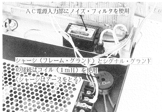
写真12 インターフェイス用マイコンのノイズ対策
