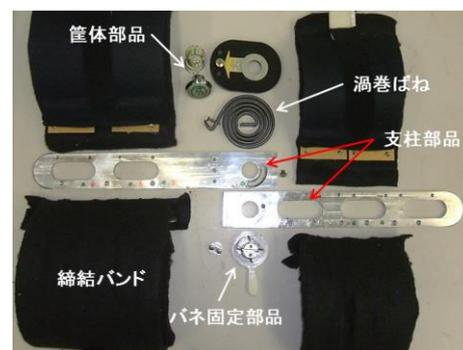
Fig.2 器具の部品構成
