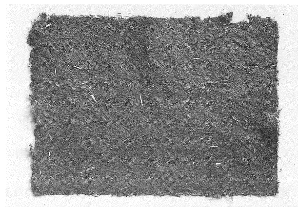
Fig. 3 蒸解したスギ樹皮パルプで抄いた紙
