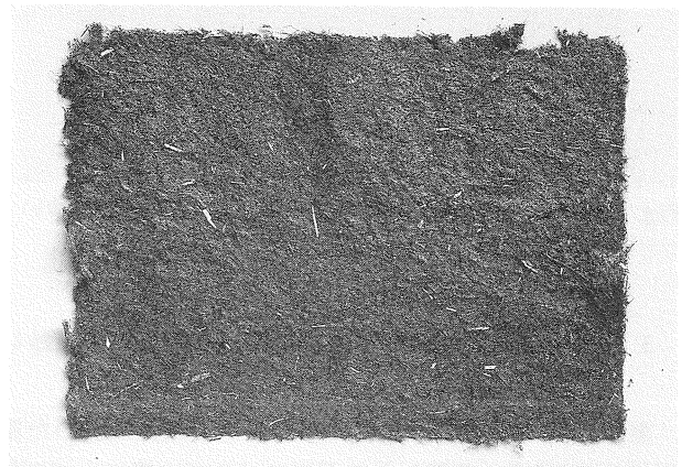
Fig. 3 蒸解したスギ樹皮パルプで抄いた紙
