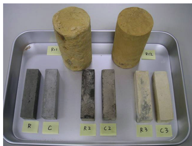
Fig.1 硫黄固化体(R)とコンクリート(C)
