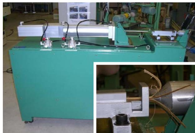
Fig.5 開発した竹材突き加工機
