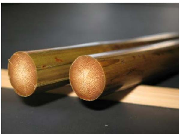
Fig.3 表皮側を長辺(下底)側にした圧密材
