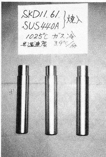
写真2：高合金鋼の真空熱処理後の試験片
