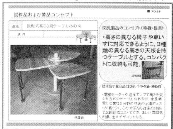
Fig.14 回転式高さ3段テーブル (NO.8)
