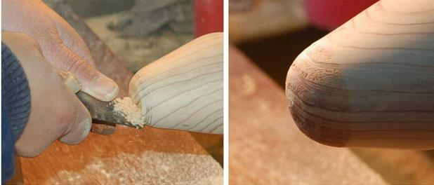
Fig. 7 木工ロクロによるスギの加工と表面の状態
