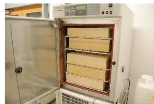
Fig. 6 恒温恒湿器による低温除湿式乾燥
