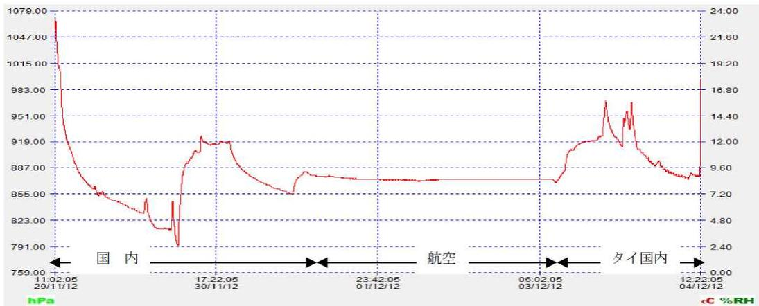
Fig. 4 輸送中の包装内温度
