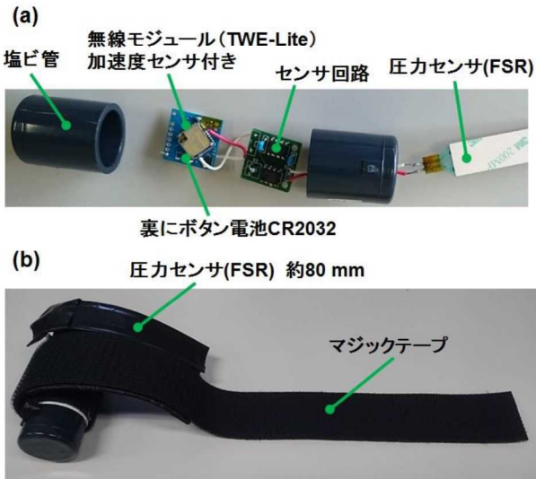
Fig. 3 試作したセンサの写真 (a)ケースの内部の写真 (b)センサの全体写真
