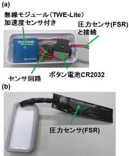
Fig. 6 小型・軽量化したセンサの写真 (a)ケースの内部の写真 (b)センサの全体写真
