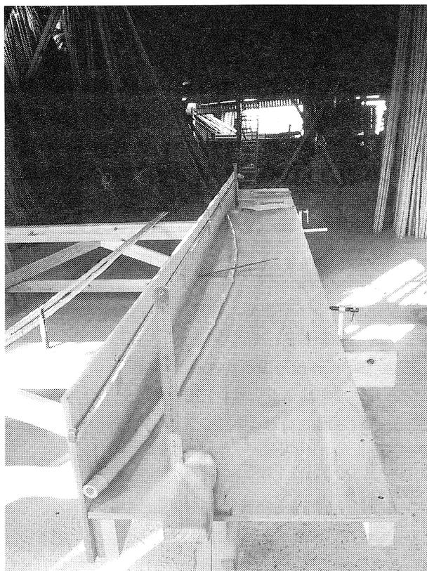
Fig.1 丸竹（直径約4cm）の実測測定台
