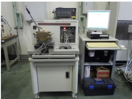
Fig. 1 混練性・押出性試験機
