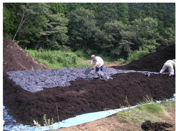
Fig. 1 吸着マットを並べる様子（実験1）
