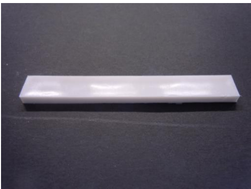
Fig. 6 短冊形試験片(ノッチ加工前)
