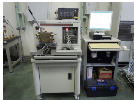
Fig. 1 混練性・押出性試験機
