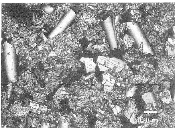
Fig.3 粉末-Aを親水処理したレーザー顕微鏡写真
