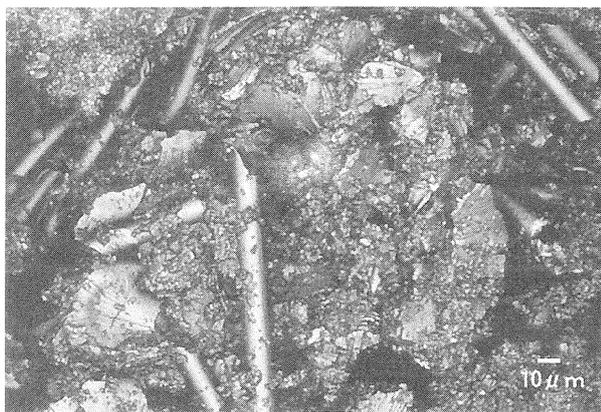
Fig.4 粉末-Bを親水処理したレーザー顕微鏡写真
