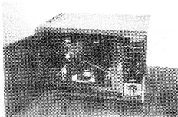
写真-2 マイクロ波照射装置
