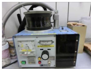
Fig. 7 オスミウムコーター（Neoc-ST）
