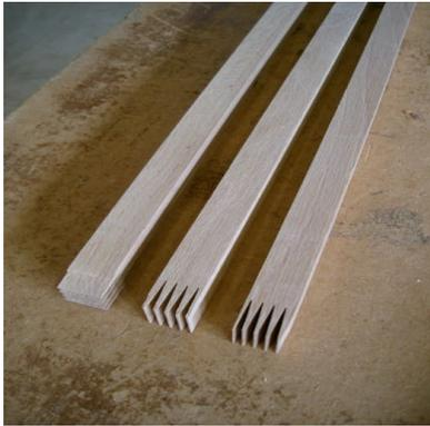
Fig.3 フィンガー加工した材
