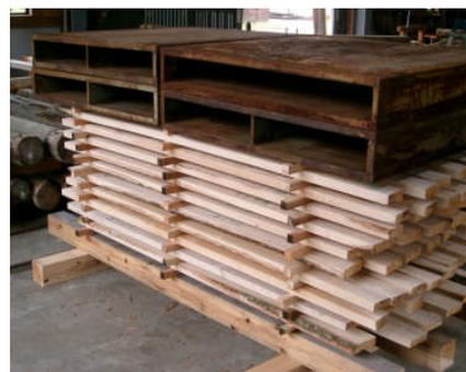
Fig.2 棧積みし、載荷した状態
