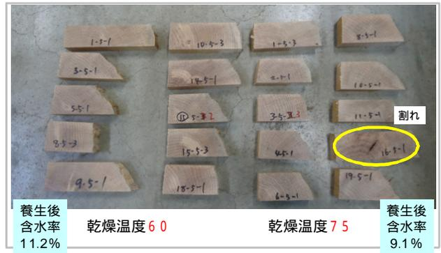
Fig.2 養生後の材の状況（板厚50mm）
