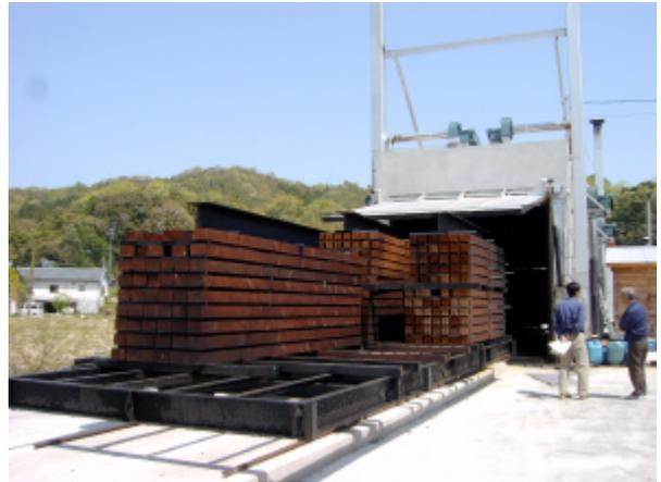
Fig.3 岩田材木展の燻煙乾燥装置と乾燥材
