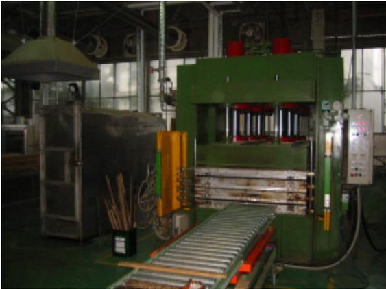
Fig.2 1,000トンのプレスができる圧密加工装置
