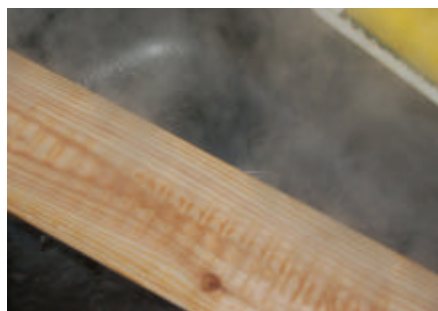
Fig.10 熱湯をかけて復元中の材
