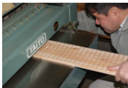
Fig.9 凸凹の溝のついたローラーでプレス
