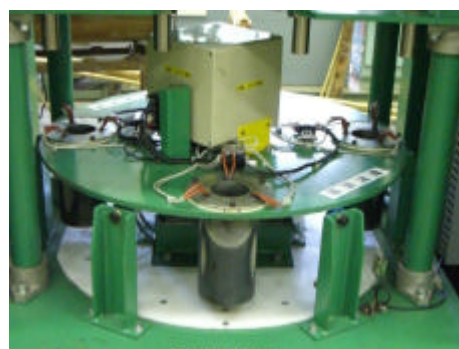
図16 ターンテーブル及び加熱部
