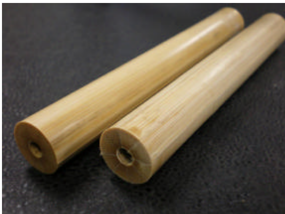
図5 押し抜き成型法による圧密コネクタ
