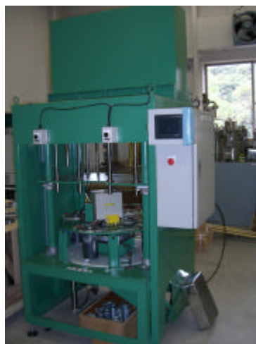
図15 押し抜き成型加工装置
