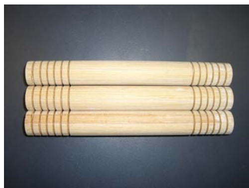
Fig. 2 両端30mmに切り込み加工したコネクタ（5mmピッチ）
