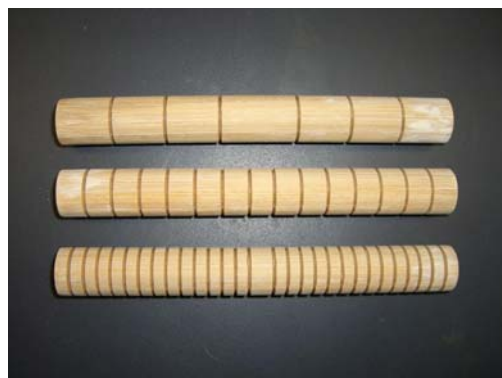
Fig. 1 表面全体に切り込み加工したコネクタ（下から5mm, 10mm, 20mmピッチ）
