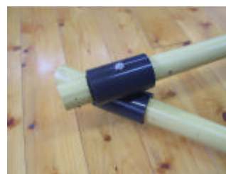
Fig.1 塩ビを用いた接合部分
