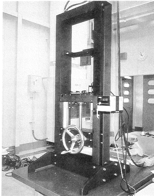
図9 弾性変形・姿勢制御実験装置本体部
