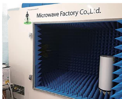
アンテナ計測システム
