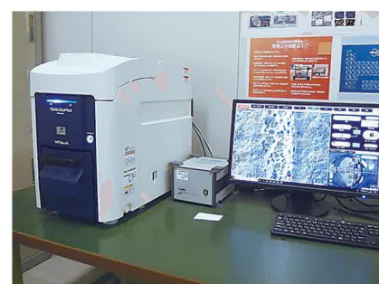
卓上型走査電子顕微鏡による金属破面の観察
