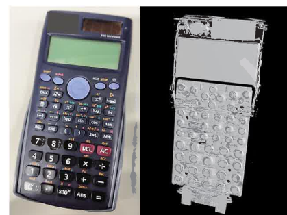
X線CTによる非破壊検査の事例
