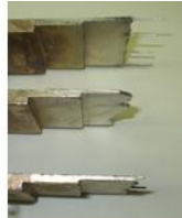
Fig.6 実証試験後の階段型铸造試験片 (設置条件 B)
