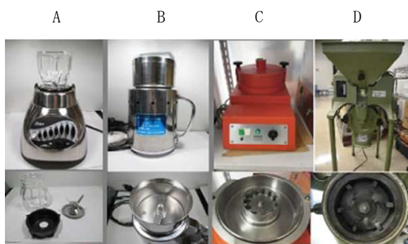
Fig.2 粉碎機 A:Oster Blender, B: Wonder Blender, C: ロータースピードミル, D: ピンミル粉碎機
