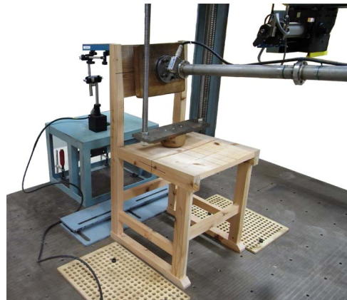
Fig.13 学校用椅子のJISに基づく強度試験
