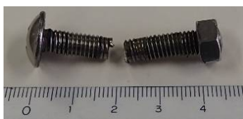
図1 使用中に破壊した支軸ボルト
