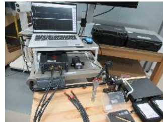
【インピーダンス測定の例(差動伝送路)】
