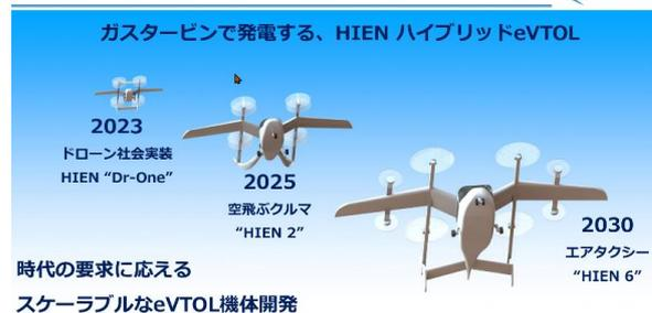
本年11月には、発電及びフライトの性能検証として、当センターのDs-Labo「ドローンテストフィールド」において浮上試験を実施しました。電池を搭載していない完全発電タイプです。1人乗り用として設計されたフレームを基本骨格とする試験機体は、無事に2回の浮上テストをクリアしました。今年度内に大分県中央飛行場などで複数の飛行試験を予定しており、当センターも積極的な支援に取り組みます。
