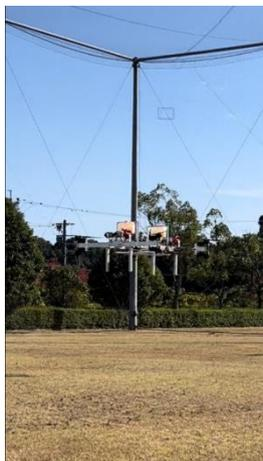
しました。空飛ぶクルマはマルチコプター型ドローンの発展型ですが、人員が搭乗するため機体が大型化します。飛行には大電力・ハイパワーを可能とする電源とモーターが必須であり、同社の空飛ぶクルマは、電源として「ガスタービン型発電機」を搭載することが大きな特徴です。一般の固体バッテリーでは長時間、大電流を得ることは困難
