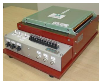
図 4 IEC 60404-16 準拠のアモルファス試験器
