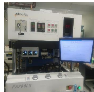
図6 接合装置の写真と仕様
