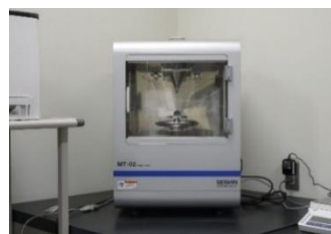
粉体特性評価装置マルチテスターMT-02（(株)セイシン企業）
