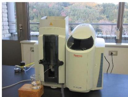
導入した装置は空気とアセチレンガスを使用した炎を用いて原子化するフレーム法で測定します。光源にはナトリウムとカリウムを測定するためのホローカソードランプを備えており、他の分析装置と比べてこれらの元素を容易に測定できます。
