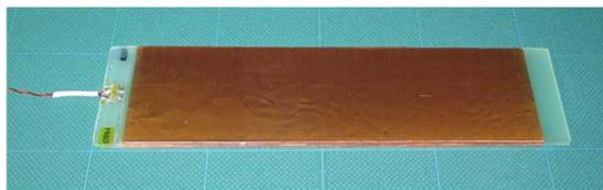
Fig. 5 磁歪測定に用いた H コイルの外観
