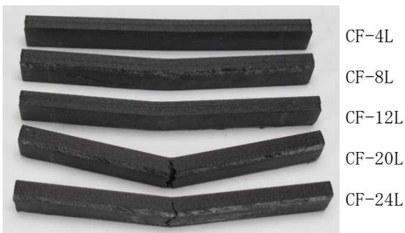
Fig. 15 樹脂材料 0.125mm 繊維材料 CF の積層 (L) 数の違いによる 3 点曲げ試験片
