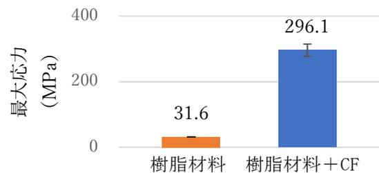
Fig. 11 樹脂材料積層ピッチ 0.2mm 平置きと長繊維CF24層複合材料平置きでの最大応力平均値比較
