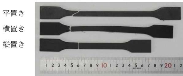
Fig. 8 積層ピッチ 0.1mm, 平置き, 横置き, 縦置きで造形した引張試験片
