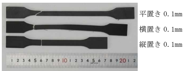
Fig. 8 積層ピッチ 0.1mm, 3 タイプの造形方向で造形した引張試験片
