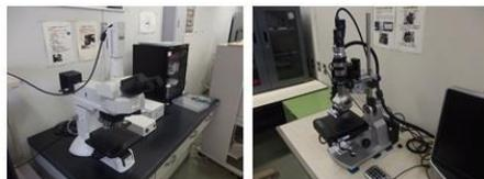
金属顕微鏡試験用機器
