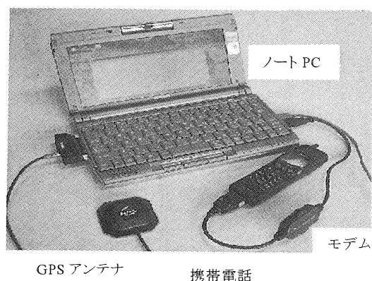
Fig.4 移動局のハードウェア構成
