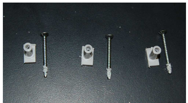
Fig. 6 ボス孔からのねじの抜けが観察できた予備実験
