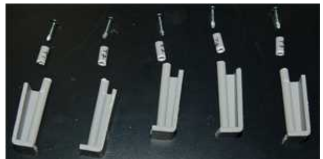
Fig. 9 汎用射出成型製品の破断の様子
