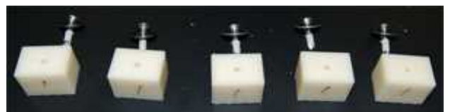
Fig. 16 3Dプリンタ造形品からのねじの抜けの様子
