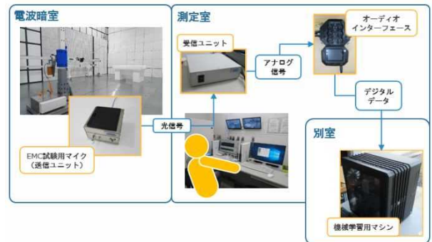
Fig.2 放射イミュニティ試験における録音環境
